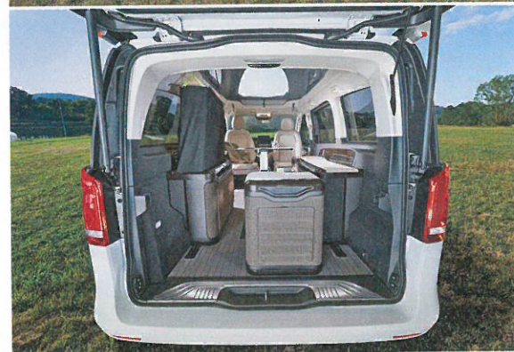
Flexibel: Hymer arbeitet im Innenraum mit herausnehmbaren Modulen, die in den Sitzschienen verankert sind.
